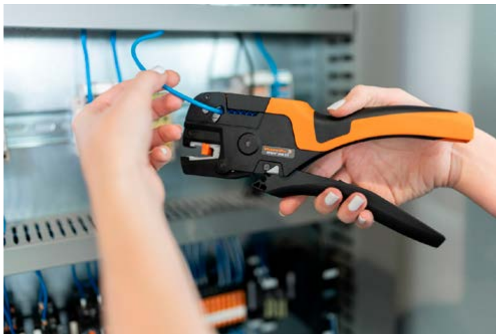
Durch das Universalgelenk ist die Wahrscheinlichkeit von Fehlern mit der stripax® plus deutlich geringer
